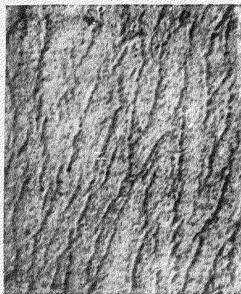
Рис. XIV. Часть тонкой структуры одной из полос скольжения, изображенных на рис. XIII. Электронномикроскопическая фотография с оттененной окисной реплики ( \times 25\,000 ).
