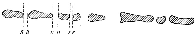
Рис. 5. Вид следа сильно ионизирующей частицы в эмульсии. Длина просветов равна AB + CD + EF + \dots
