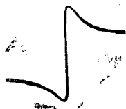
Рис. 9. Форма сигнала дисперсии от протонов в воде.
