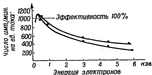
Рис. 28. Зависимость эффективности счёта электронов умножителем с медно-бериллиевыми эмиттерами от энергии электронов. Импульсы умножителя усиливались усилителем. Верхняя кривая снята при усилении усилителя, вдвое большем, чем нижняя.
