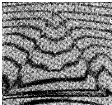
Рис. 22. Деталь поверхности, изображённой на рис. 20; увеличение 1260\times . Пластины интерферометра взаимно наклонены.
