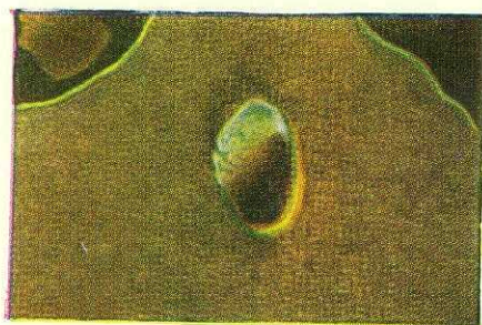
Рис. 26. Смешанный фазово-амплитудно-поляризационный контраст. Кусочек стекла.
