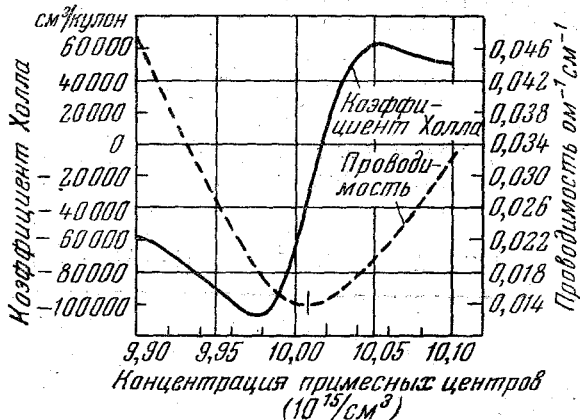
Рис. 10. Коэффициент Холла и проводимость германия в состоянии теплового равновесия как функция концентрации примесных центров, созданных облучением нейтронами.
