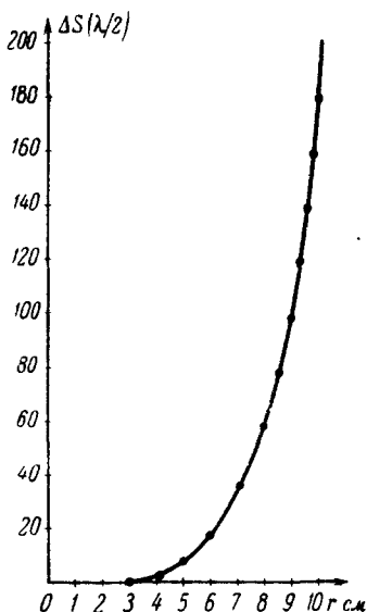
Рис. 12. График зависимости разности хода \Delta S (в единицах \lambda/2 = 2,5 \cdot 10^{-5} см) от r — расстояния точки (в см) на поверхности зеркала до главной оптической оси зонной пластинки.
