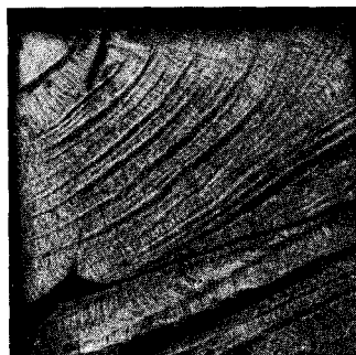
Рис. 13. Кольца разлома на поверхности спайного скола у ступеньки на поверхности.
