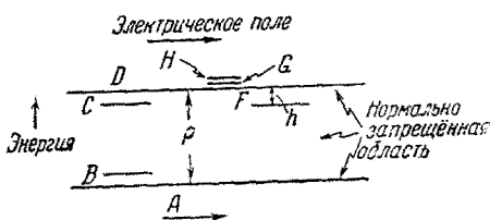
Рис. 2. Диаграмма уровней энергии для непроводящего кристалла, в котором имеются ловушки ( F ) и атомы неоднородности ( BC ).
