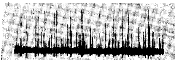
Рис. 1. Оциллограмма регистрации S^{32}(n, p)P^{32} и S^{32}(n, \alpha)Si^{29} реакции в ионизационной камере.
