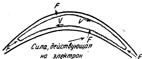
Рис. 3. Возможные траектории электронов, движущихся в ионном пучке в обычном масспектрографе, иллюстрирующие захват медленных электронов.
