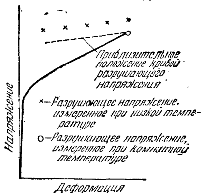
Рис. 2. Метод нахождения кривой действительного разрушающего напряжения.
