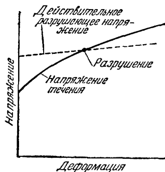
Рис. 1. Представление о разрушении металла по Лудвику.
