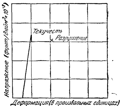
Рис. 4. Понижение разрушающего напряжения благодаря начальной деформации (перлитная сталь при -190^{\circ}\text{C} ).
