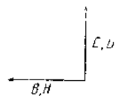
Рис. 1. Соотношение между векторами \mathbf{E} , \mathbf{D} и \mathbf{H} , \mathbf{B} в плоской волне, распространяющейся в направлении, перпендикулярном к плоскости чертежа.
