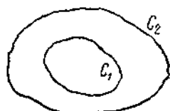
Рис. 4. Схема сечения резонатора с двойными стенками.
