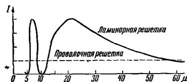
Рис. 29. Приблизительный ход кривой интенсивности I в спектре первого порядка у ламинарной решетки ( h = 5 \mu ) — и у проволочной решетки —
