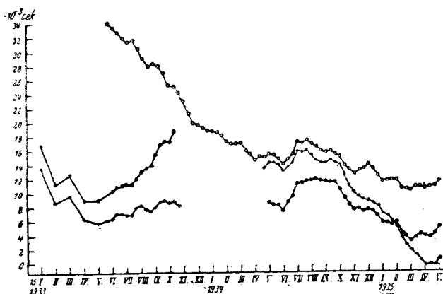
Рис. 33. Измеренные значения среднего хода \bar{G} кварцевых часов I (...), II (+ + +) и III (....)
