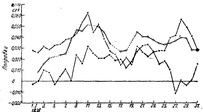
Рис. 6. Поправки к сигналу времени Рэгби, передаваемому в 11 h 00 m по данным Потсдама (.,.), Гамбурга (+++), Парижа (...).
