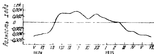
Рис. 36. Изменение разности между вычисленными и измеренными значениями хода кварцевых часов Геодезического института в Потсдаме
