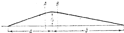
Рис. 3. Путь луча в „короткой“ электронной линзе
