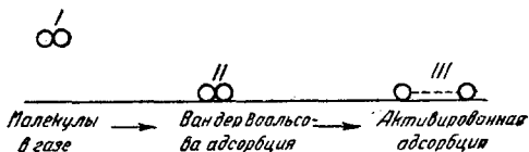
Рис. 24. Схема высоко и низкотемпературного катализа: q — теплота ван-дер-ваальсовой адсорбции, E — теплота активации при активированной ван-дер-ваальсовой адсорбции, Q — теплоте адсорбции при ван-дер-ваальсовой активированной адсорбции.
