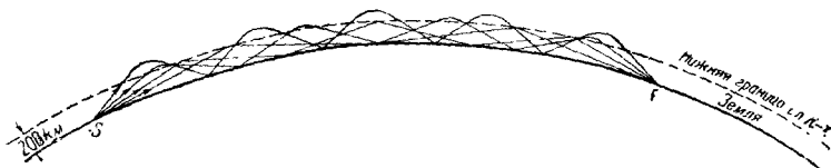
Рис. 5. Зигзагообразное отражение при трансокеанской связи.
