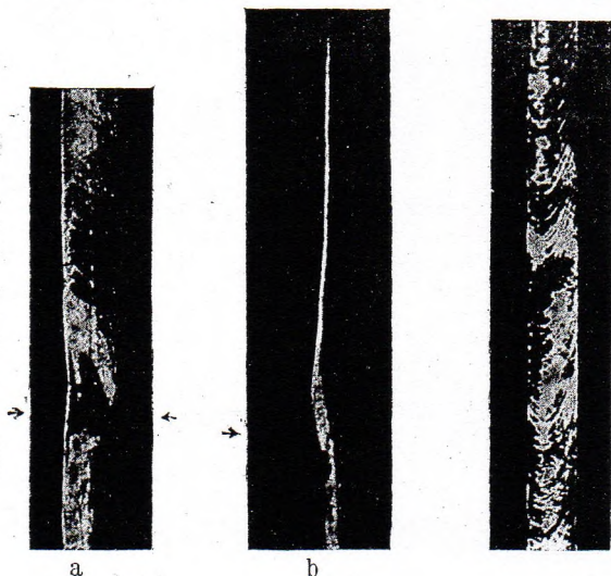
Рис. 5, a и b показывают растянутую однокристалльную проволочку цинка: a перпендикулярно к широкой стороне ленты, b параллельно ей. Снизу до стрелки кристалл остается нерастянутым, и первоначальная приблизительно цилиндрическая форма не изменена. Начиная отсюда вверх ширина ленты несколько превосходит толщину исходной проволочки. На рис. 5, c показана еще одна растянутая цинковая проволочка с хорошо видными линиями скольжения, причем последние явственно отклоняются от средней линии ленты.
