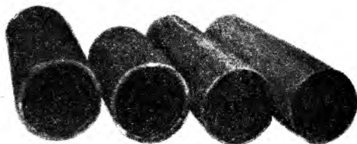
Рис. 3. Стальные трубы диаметром один дюйм, сваренные по длине в пламени атомного водорода.
